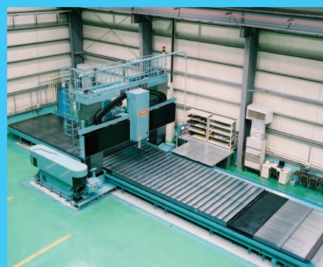
大型 5 面加工機 （テーブルサイズ 3,500 \times 8,000\text{mm} ）
