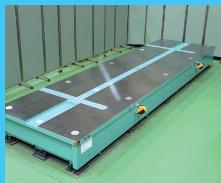
超大型精密製造定盤（自社製） （ 1,500 \times 5,600\text{mm} 、平面度 10\mu\text{m} ）
