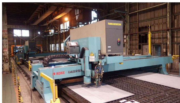
NCレーザー切断機(6kW)
