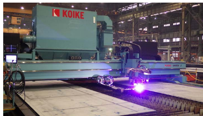
NCプラズマ切断機
