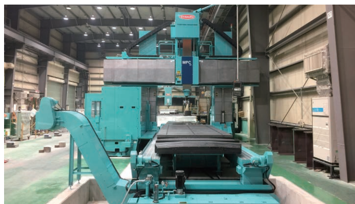
精密5面加工機(テーブルサイズ2,000×5,000mm)
