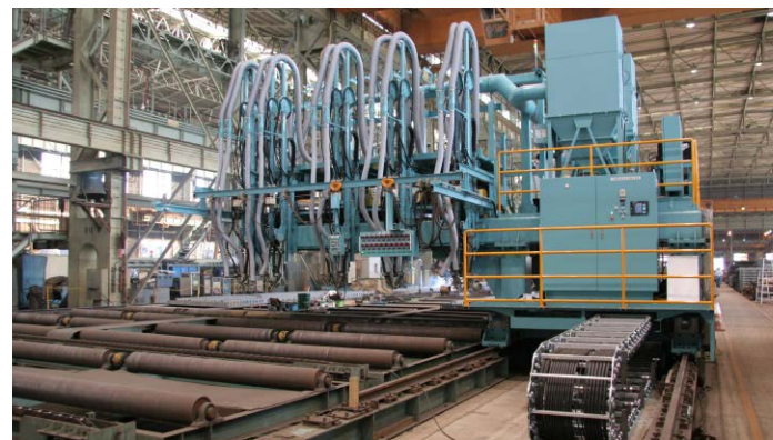
10電極自動溶接装置
