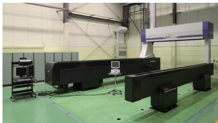
超大型三次元測定機(ミットヨ社製) (測定範囲 3,000×6,000×2,000mm)
