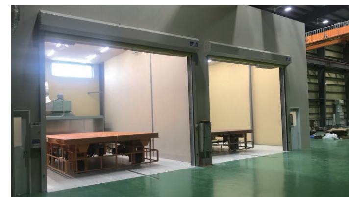
塗装ブース(常温塗装)
