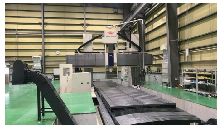
大型5面加工機(テーブルサイズ3,100×8,000mm)
