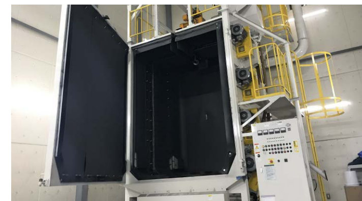
自動ブラスト機(ブラスト可能サイズφ2000×2500mm)
