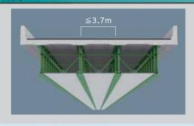
桁下にキュウサを設置できない場合で桁間に設置する形式。 パネル受け部(アルミ受材)が無い構造形式です。
