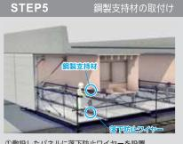
①敷設したパネルに落下防止ワイヤーを設置。 ②既設桁に孔あけをし、銅製支持材を取付け。 ③銅製支持材と裏面パネル受材を接合。
