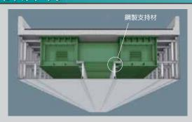
橋梁本体に支持材を設置し、キュウサのアルミ部材で床 版から下側の構造を覆う構造形式です。
