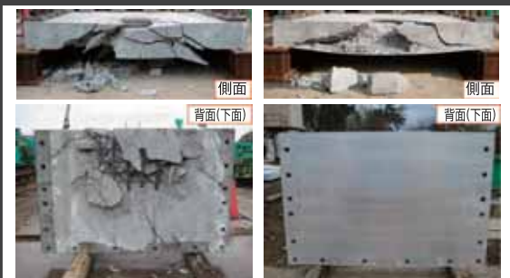
写真 3 : コンクリート供試体破壊状況 写真 4 : アルミ + コンクリート供試体破壊状況
