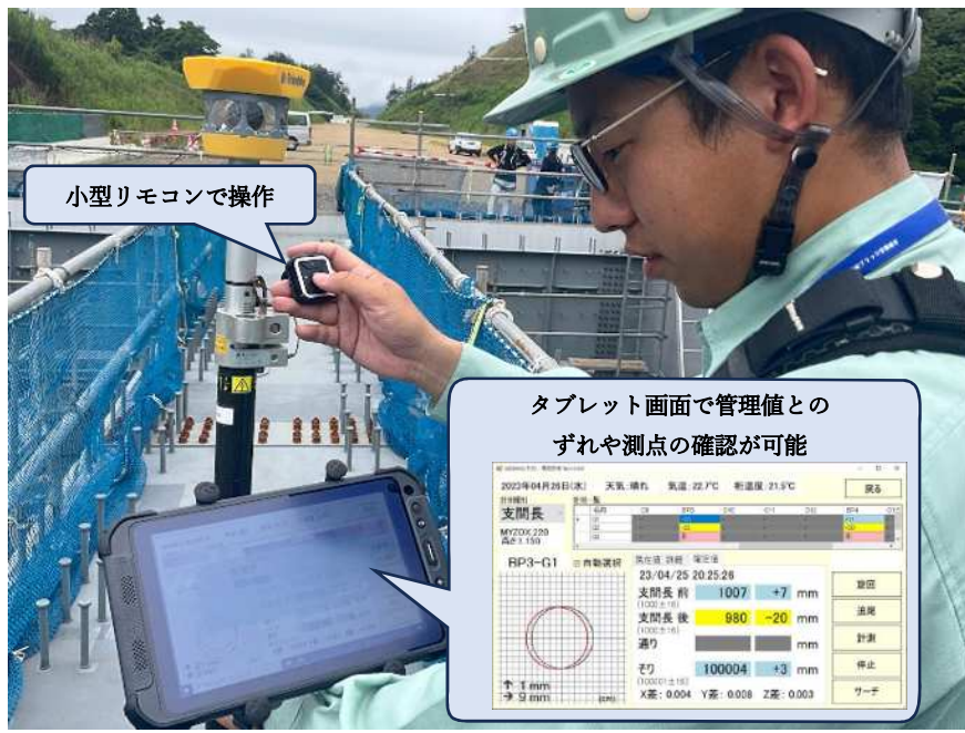
写真-2 小型リモコンとタブレットにより操作性・視認性が向上
